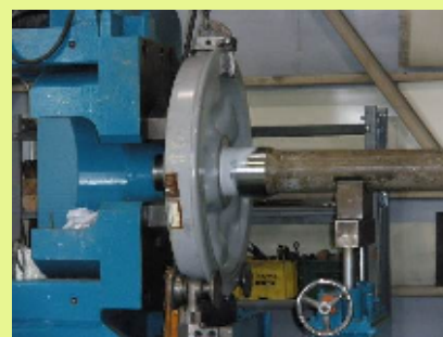
電車重要部検査（車輪交換）
