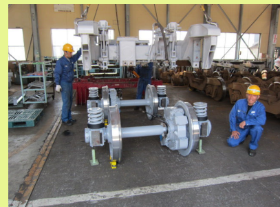
電車重要部検査（台車検査）
