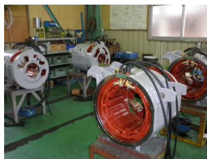
主電動機（モーター）整備
