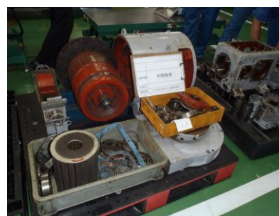
空気圧縮機整備
