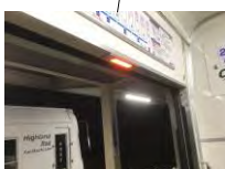
扉開閉予告灯
